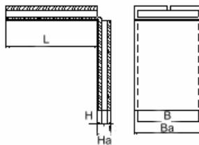
Die PU Kantenschutzwinkel KWL sind konzipiert für die Verwendung mit Polyesterhebebändern. Sie sind flacher als die Kantenschutzwinkel KW. Die Formstabilität resultiert aus dem Einsatz einer Lochblechwinkel, der in der Polyurethanmatrix vergossen ist. Durch die oberseitige Trenn- und Führungsnut lassen sich die Polyesterhebebänder leicht in die Kantenschutzwinkel KWL einführen.
